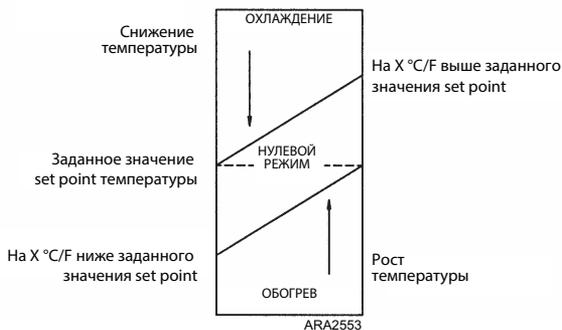
Заводская настройка для X составляет 3 °C (5 °F). Во время монтажа установки это значение можно изменять в пределах от 1 до 5 °C (2–9 °F) с шагом 1 °C/F.
